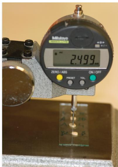
Figura 1 Misurazione degli spessori dei compositi con un comparatore.
